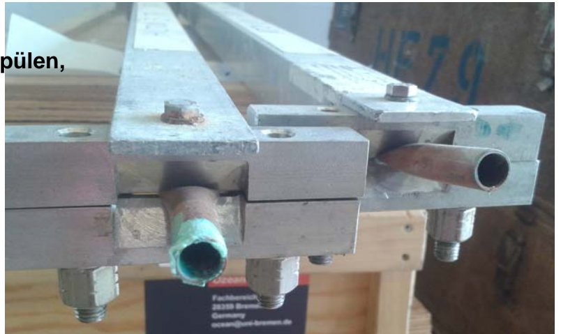
Abb. 3 & 4: Zuschrauben der Klemmen: zunächst der Abfluss, dann der Zufluss
