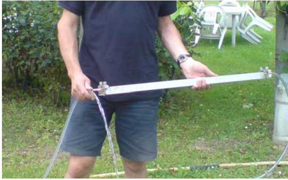
Abb. 1: Aufsetzen des durchsichtigen 10mm Tygon-Schlauchs
