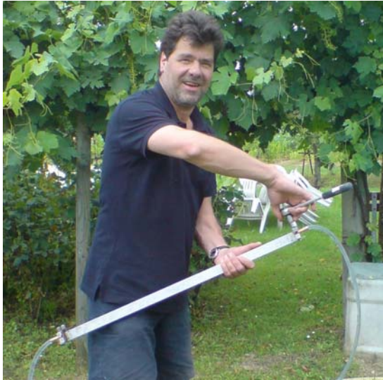
Abb. 3 & 4: Zuschrauben der Klemmen: zunächst der Abfluss, dann der Zufluss
